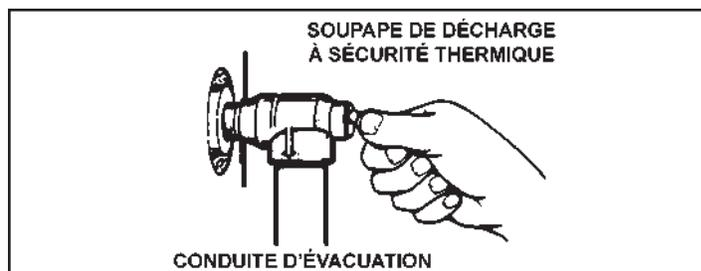
Figure 13. Test de la soupape de sûreté T&P
